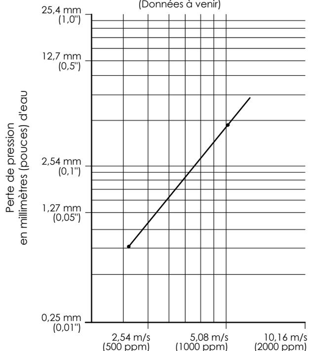
Vitesse de l'air au travers de la surface libre en mètre par seconde (pieds par minute)
