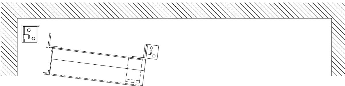
2 : Fixer la persienne au mur, par l'angle d'attache. Fixer l'angle de fin.
